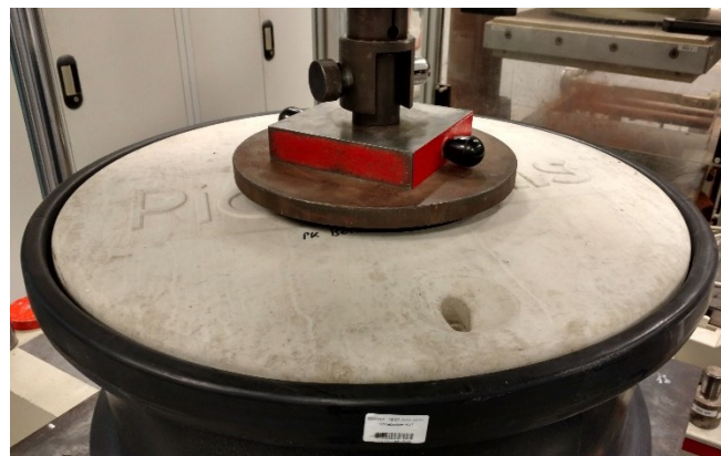
Fig. 2: Tampon d'essai d = 250 mm, couche intermédiaire en caoutchouc
